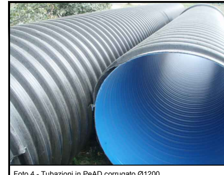
Foto 4 - Tubazioni in PeAD corrugato Ø1200
