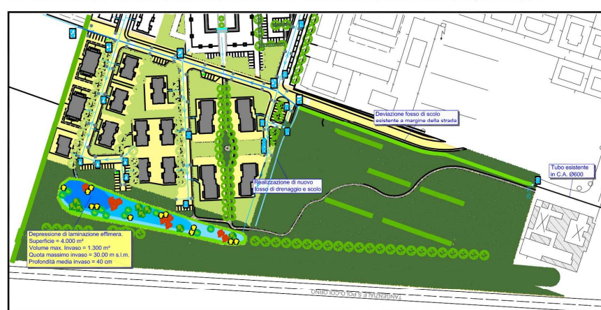
PLANIMETRIA DI PROGETTO DELLE RETI DI COLLETTAMENTO E LAMINAZIONE ACQUE BIANCHE
