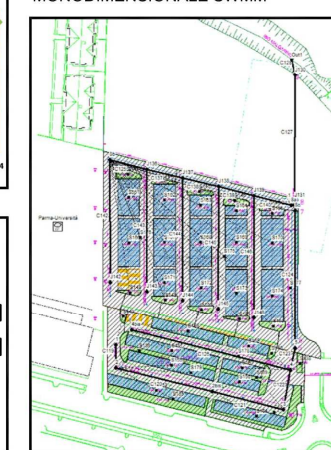
SCHEMATIZZAZIONE DEL COMPARTO ATTRAVERSO IL MODELLO MONODIMENSIONALE SWMM
